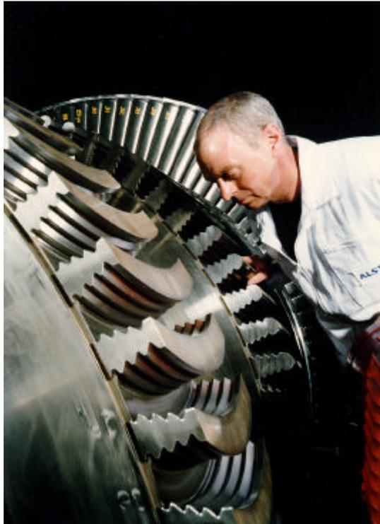
Figura 3.5 – Fixação das Palhetas móveis
