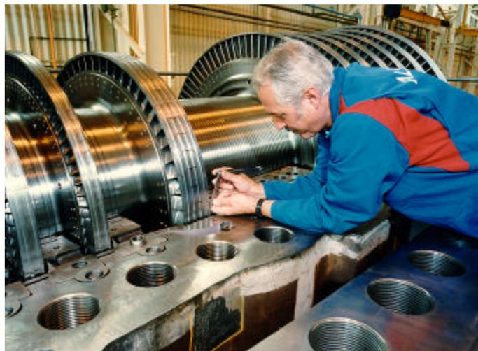
Figura 3.1 – Estator, Eixo do Rotor e Palhetas Móveis
