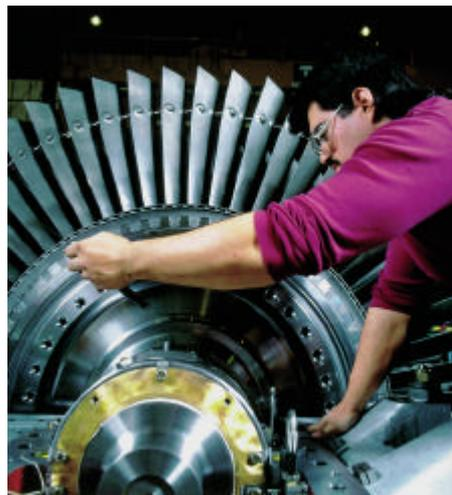
Figura 3.12 – Mancal em uma Turbina a Vapor
